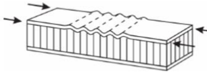
Figure 1.11. Flambement localisé « wrinkling » [28].
