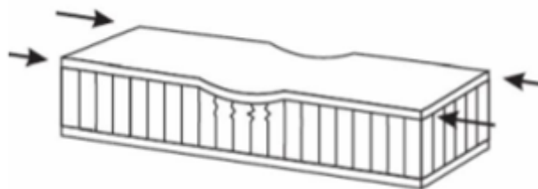
Figure 1.12 Flambement généralisé « dimpling » [28].
