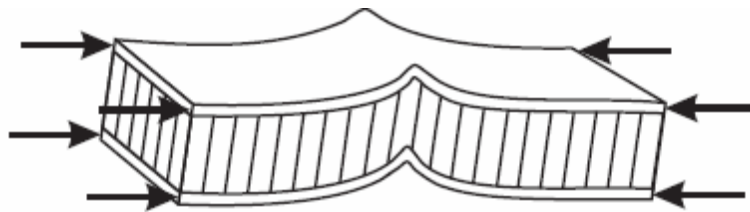
Figure 1.7 Rupture des peaux en traction et en compression [30].
