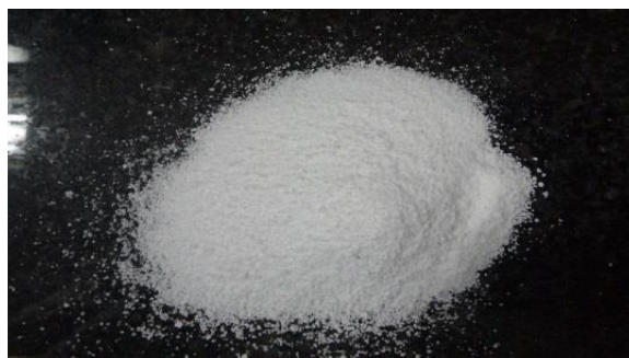
Figure III.2 : PEHD 5502 sous forme d'une poudre.
