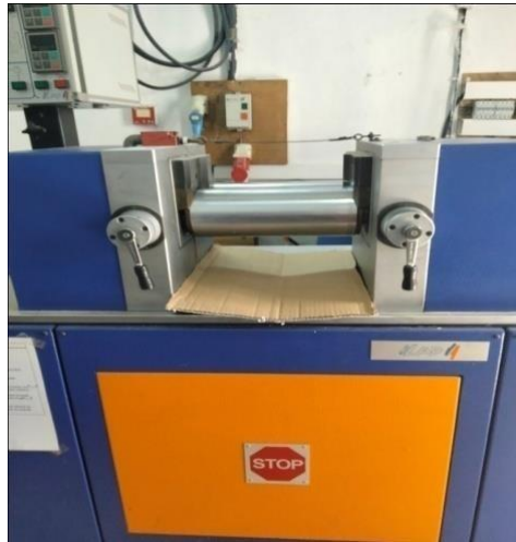
Figure III.4. : Mélangeur à deux cylindres de marque IQAP LAP –RLS-110.
