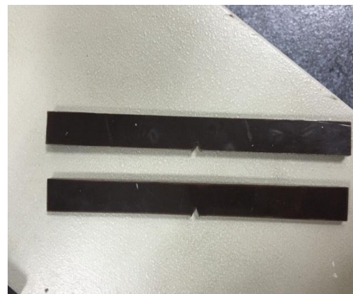
Figure III.10 : Appareillage et agencement expérimental pour le calcul de la résilience et les éprouvettes pour le test IZOD.
