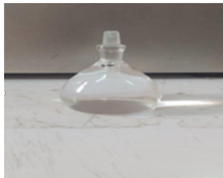
Figure III.7 : Pycnomètre utilisé pour déterminer la densité.
