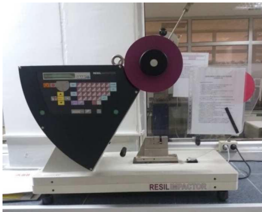
Figure III.10 : Appareillage et agencement expérimental pour le calcul de la résilience et les éprouvettes pour le test IZOD.
