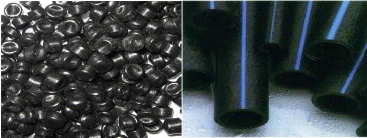
Figure I.6 : Matière première de PE sous forme de granulés et de tubes en PEHD [20].
