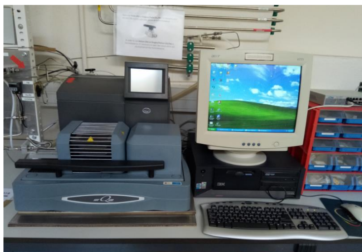
Figure IV.4. Principe du montage d'un analyseur thermogravimétrique (ATG) utilisé
