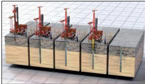
Fig. 4 Renforcement du sol par les micros pieux
