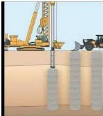
Fig. 3 Renforcement du sol par les colonnes ballastées
