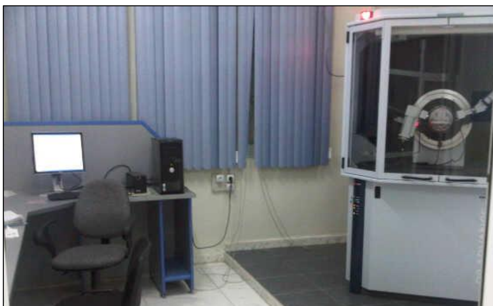
Figure III.16 : Diffractomètre De type D8 ADVANCE Bruker (laboratoire de DRX, université de BISKRA)
