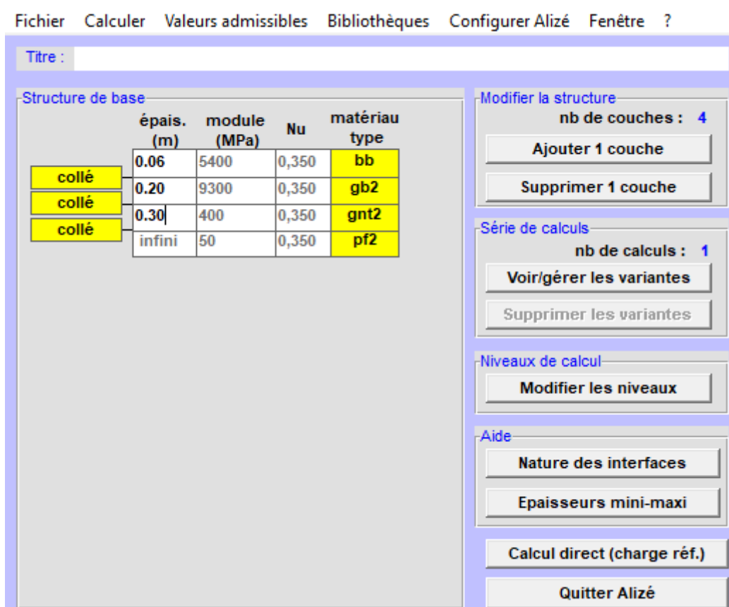
Figure IV.7 : Structure de chaussée pour les calculs Alizé-mécanique.
