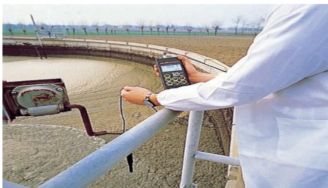
Figure II.21 : Mesure de la teneur en oxygène dissous (OD)
