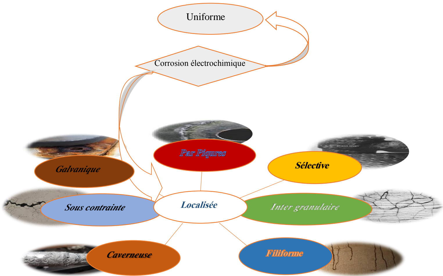
Figure I.7 : Un diagramme montrant les formes de corrosion
