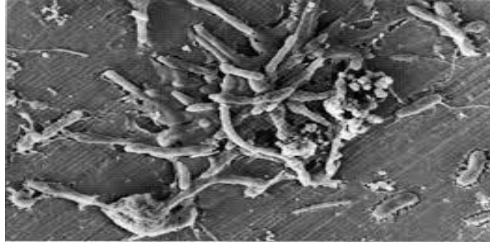
Figure I.4 : Corrosion biochimique (bactérienne) [18].
