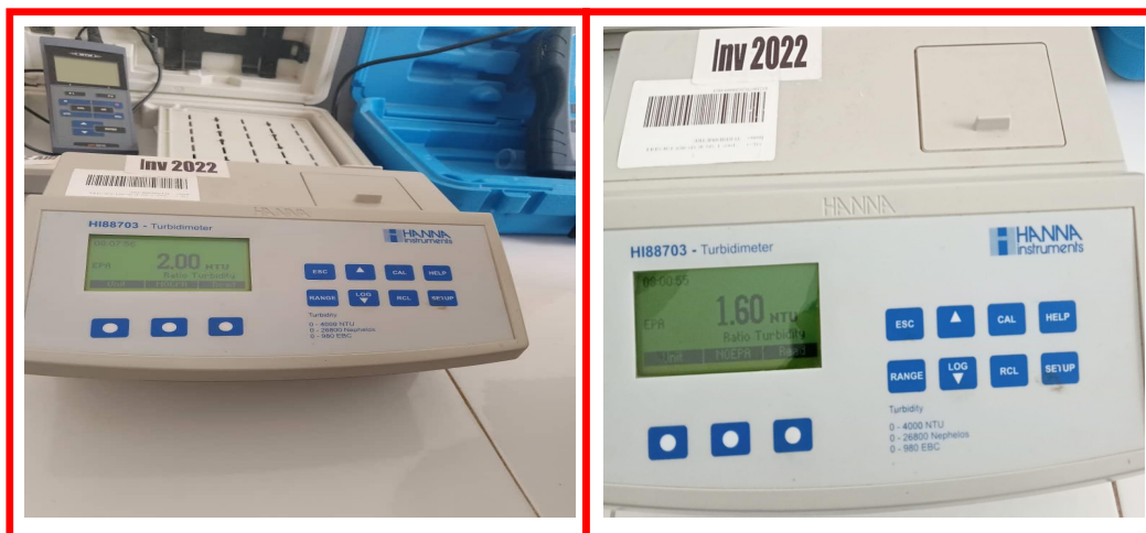
Figure II.4. Le turbidimètre (mesure de la turbidité).
