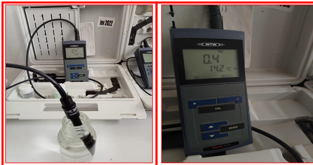
Figure II.3. Le conductimètre pour les mesures de la conductivité électrique.
