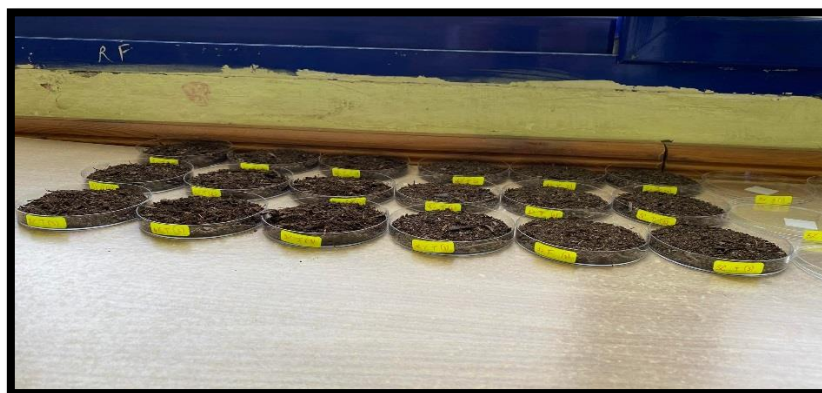
Figure III.23 : Dégradation au sol
