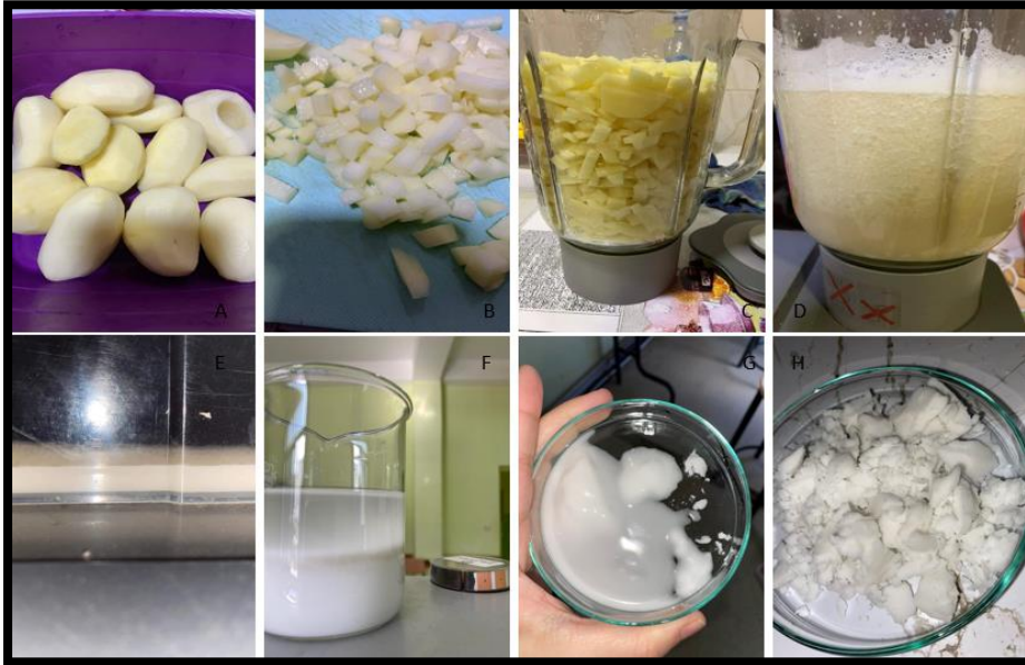
Figure III.19 : Les différentes étapes d'extraction de l'amidon naturel de la pomme de terre
