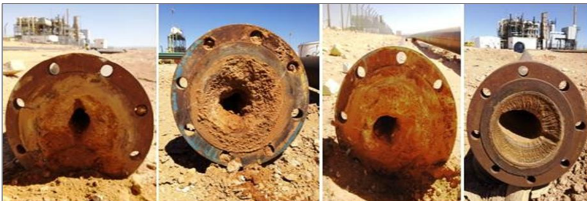
Figure I.3.3: Dépôt de sulfate de baryum au niveau de l'unité de production STAH (10/05/2010)
