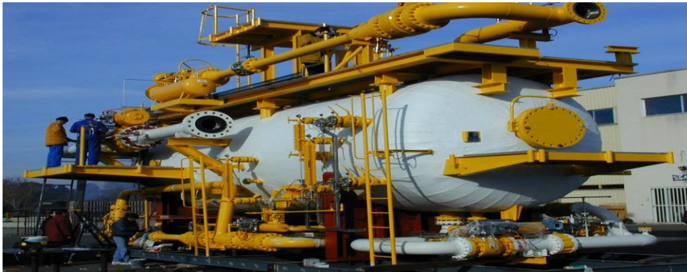
Figure II.5 : Vue d'un séparateur triphasique
