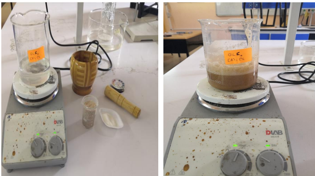
Figure II. 2 Extraction de la chitine en une seule étape.
