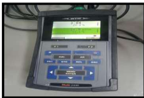
Figure 06. Photographie de l'appareil de mesure de pH, O2 et Conductivité électrique.
