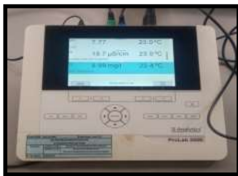
Figure 07. Photographie d'un pH-mètre, conductimètre de type SI Analytics PRO Lab 2500
