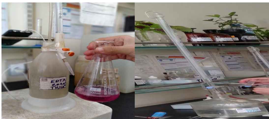
Figure IV.12. titrage volumétrique des calciums
