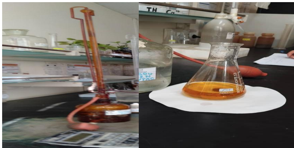
682 683 Figure IV.13. titrage volumétrique des chlorures
