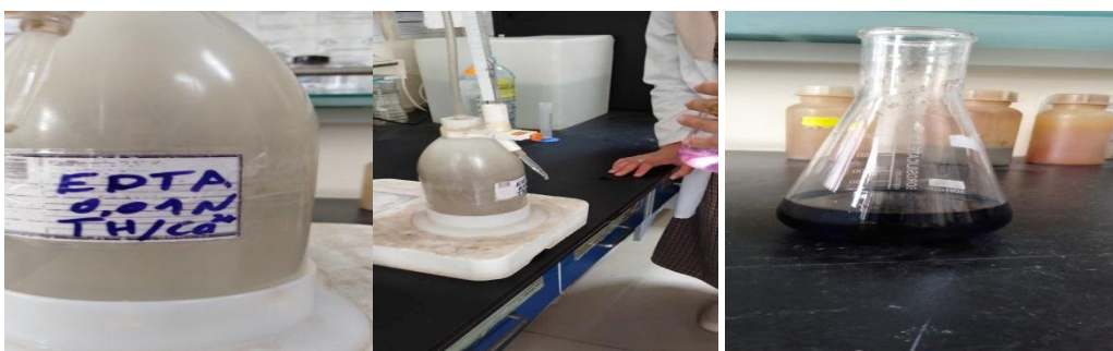
486 Figure IV.8. titrage volumétrique des dureté
