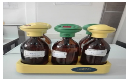
Figure15 : réactifs + le ballon de débordement. figure16 : bouteille d'incubation + la tête de lecture.
