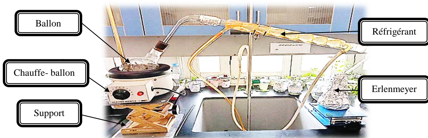
Figure 13 : Montage d'hydro distillation (photo personnelle).
