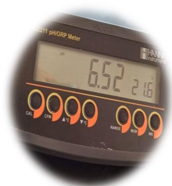
Figure 25 : Détermination ph (photo personnelle).
