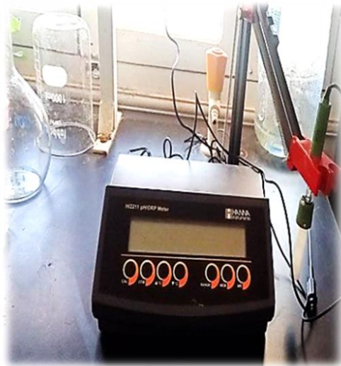
Figure 17 : L'appareil de Ph (photo personnelle).
