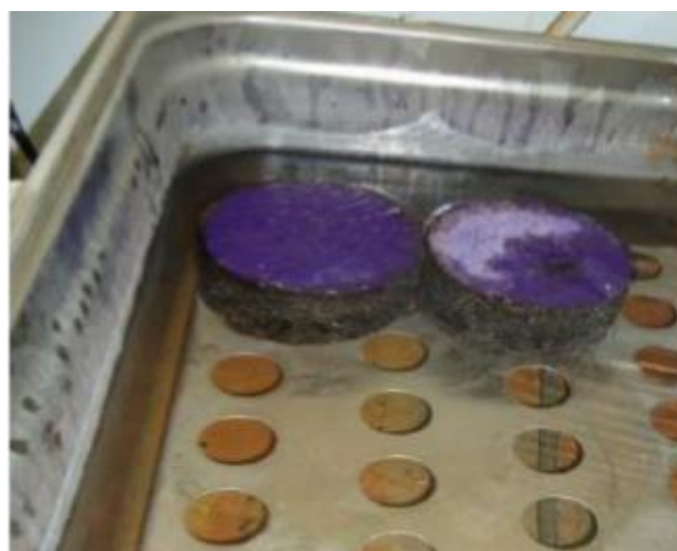
Figure II.13 Conservation des éprouvettes avant écrasement.
