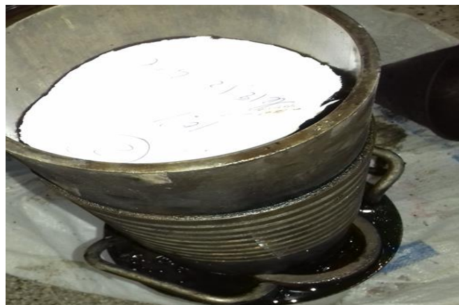
Photo IV.5 Remplissage des moules Duriez
