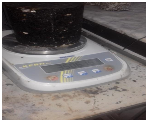
Photo IV.7 Peser hydrostatique les éprouvettes Duriez
