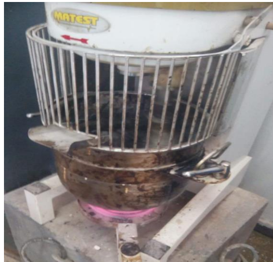
Photo IV.4 Malaxeur de mélanges bitumineux
