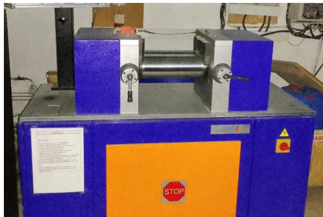
Figure III.6 : Vue d'ensemble de la calandre utilisée lors de la préparation des composites.
