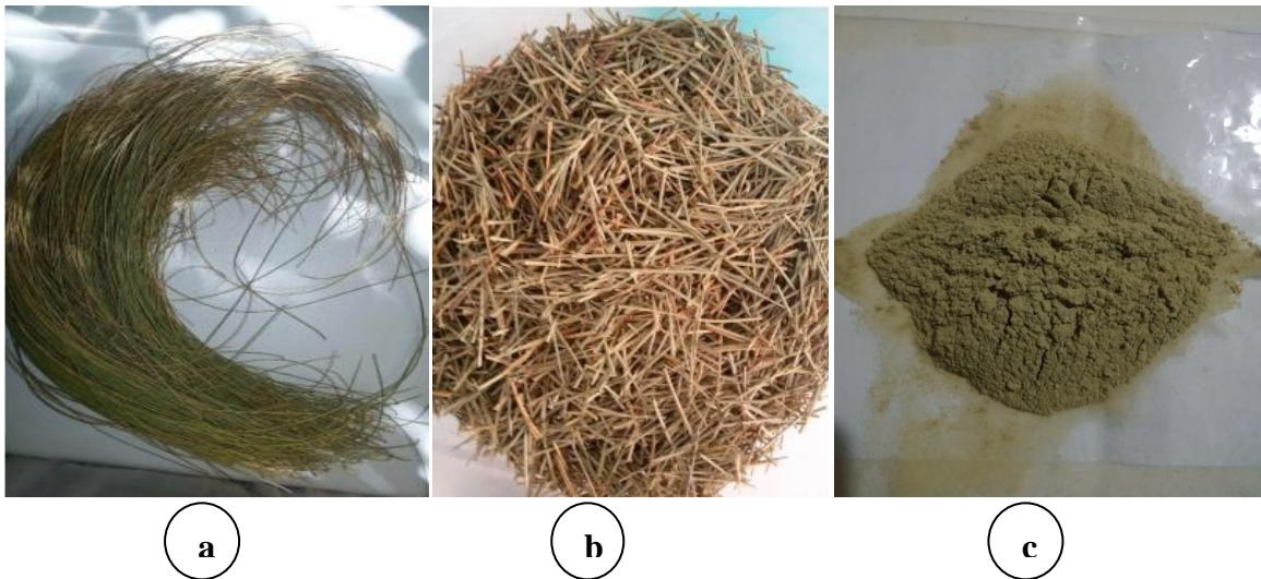
Figure III.3 : Préparation physique de la fibre d'alfa : (a) les tiges d'alfa récoltées, (b) la fibre d'alfa découpée, (c) la fibre d'alfa broyée et tamisée.
