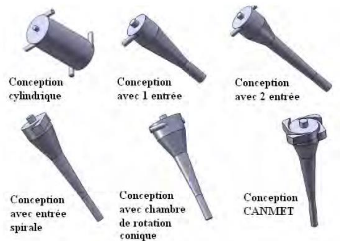
Figure II.14 : Evolution de la géométrie de l'hydrocyclone déshuileur.
