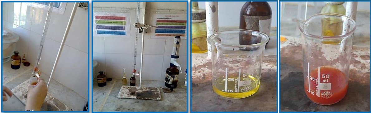
Photos 06, 07, 08 et 09. Protocole et résultat du dosage des chlorures (Photos personnelles)
