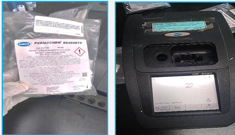
Photos 03 et 04. Réactif NitriVer et Spectrophotomètre (DR 2800) (Photos personnelles)
