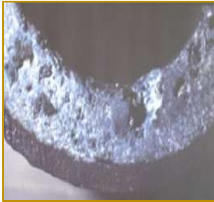
Figure 15: Dépôt de forte épaisseur dans un tube de surchauffeur de Chaudière MP.
