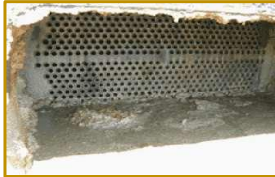
Figure 17: Dépôt de slime bactérien, hydrocarbures et oxydes métalliques dans un échangeur de chaleur eau hydrocarbures (Raffinerie de pétrole).
