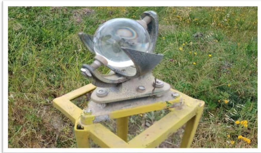
Figure I.13. Appareil de mesure du rayonnement solaire "l'héliographe " au barrage d'El Kenitra, dans la commune d'Oum Toub (ouest de Skikda), (Photo : 8 mai2023)
