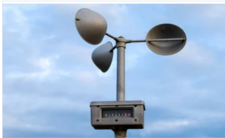
345 346 Figure I.12. Anémomètre instrument mesurant la vitesse du vent
