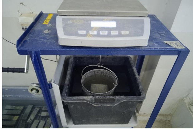
Figure III.30 : Essai de porosité par pesée hydrostatique.
