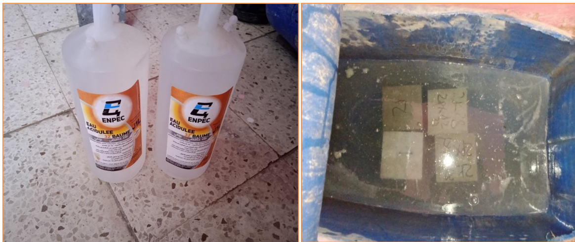
Figure III.33 : Solution acide sulfurique avec des éprouvettes.
