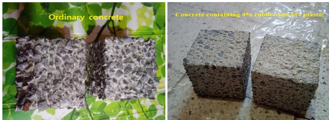
Figure VII.4 : Examen visuel des échantillons après leur immersion dans une solution à 5% H_2SO_4 pour 60 jours.
