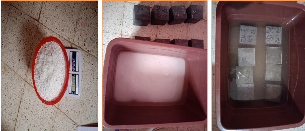
Figure III.32 : Solution nitrate d'ammonium avec des éprouvettes.
