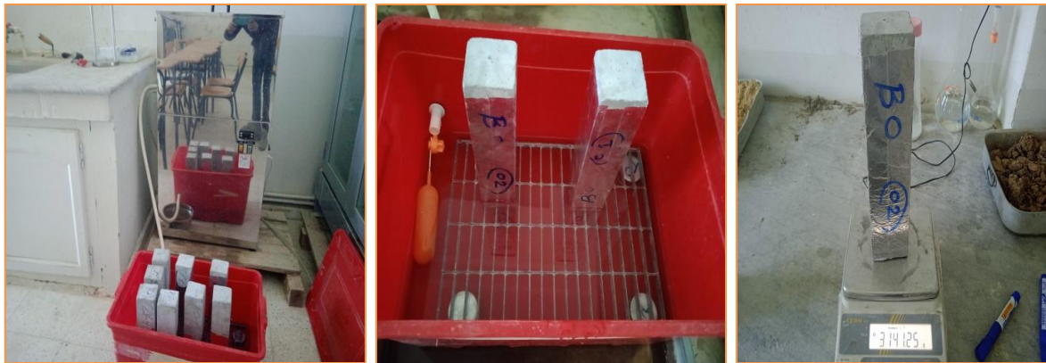
Figure III.29 : Essai absorption d'eau par capillarité.
