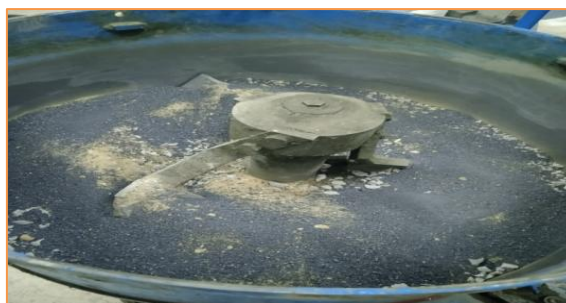
Figure III.20 : Malaxeur de béton.
