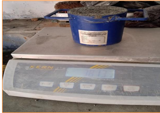
Figure III.23 : La masse volumique du béton frais.
