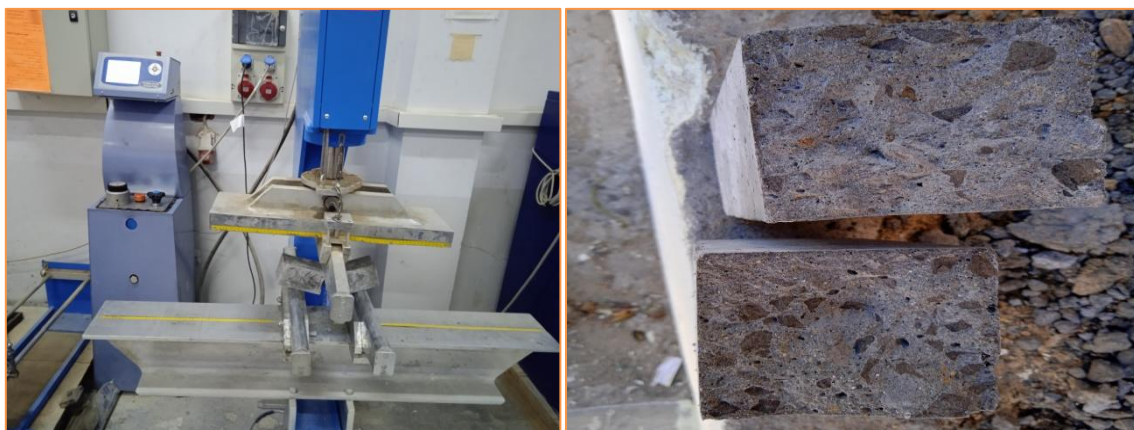
Figure III.27 : a) Machine de traction par flexion. b) Les éprouvettes après décrassement.
