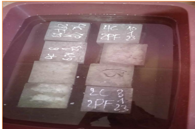
Figure III.31 : Essai absorption d'eau par immersion total.
