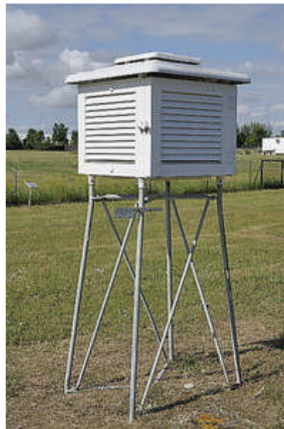
Fig. 7- Mesure de la Température dans une station météorologique (thermomètre).
