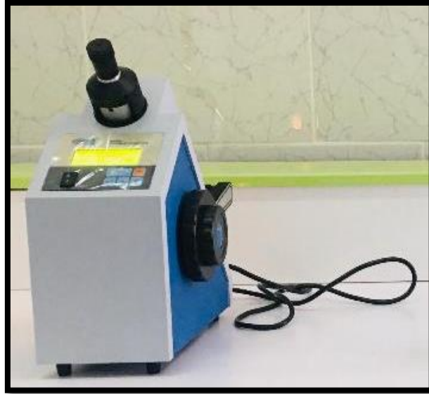
Figure n° 14: Appareil à mesurer l'indice de Brix.
