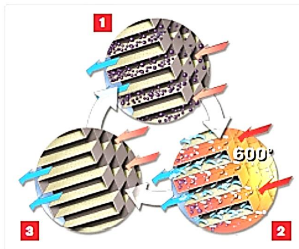
Figure 2.3 Cycle de filtration (Nissan). 1) filtre encrassé 2) combustion de la suie 3) filtre propre
