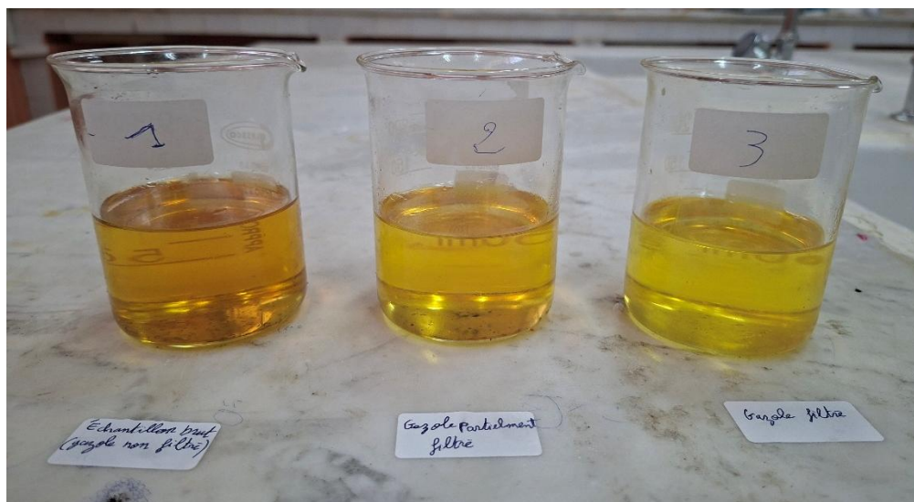
Figure III.8 : Comparaison visuelle des filtrats des 3 essais - avant et après filtration ( photo comparative )
