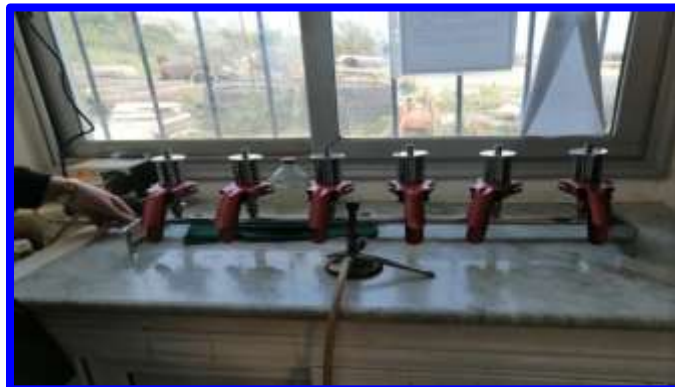
Figure.II.12. La rampe de filtration.
