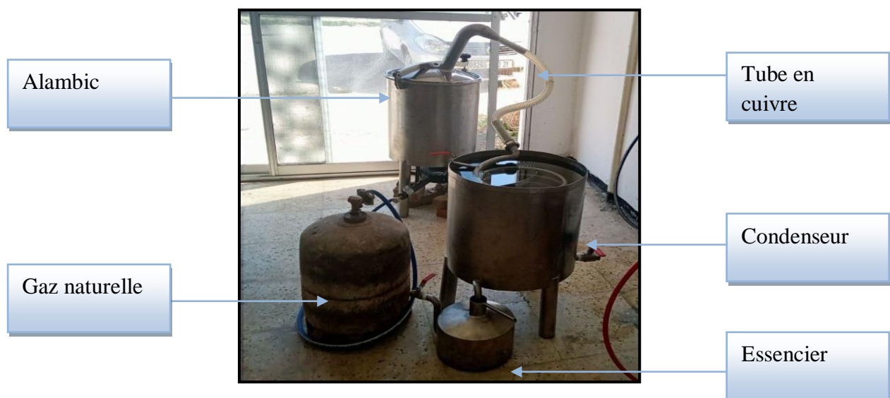
Figure 10 : Appareil d'Hydrodistillation (Photo original).
