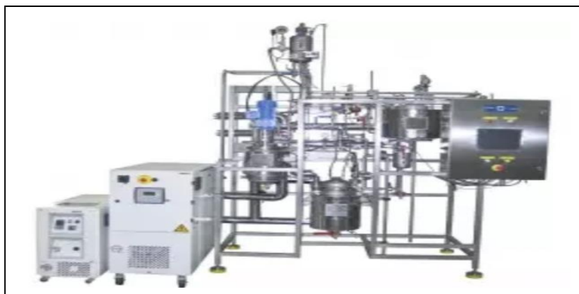
Figure 26 : Unités d'extraction à l'eau subcritique.
