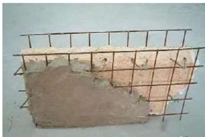
Figure I.13 : Panneau 3D en BS projeté [Benaissa, 2008]
