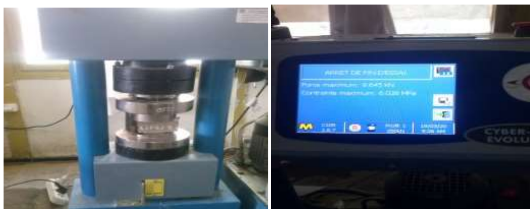
Figure II. 6 : Essai de la résistance en compression
