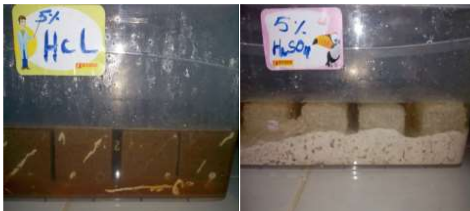
Figure II.12 : Les éprouvettes cubiques dans les solutions agressives
