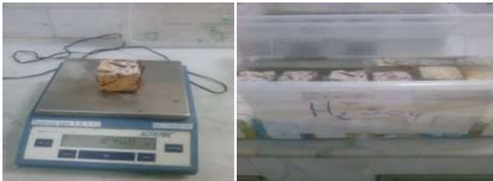
Figure II.10 : Eprouvettes immergées dans 5% H 2 SO 4
