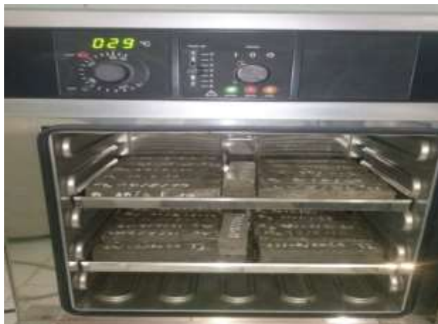
Figure II. 7 : Etuves pour l'essai d'absorption par immersion
