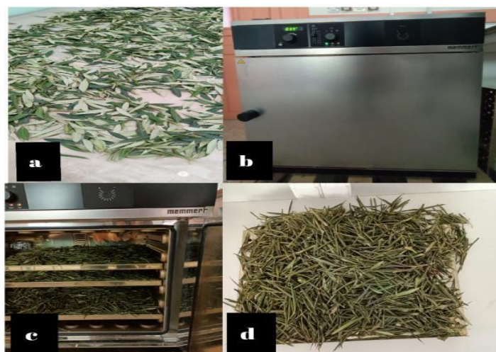
Figure 04 : Séchage des feuilles (a : séchage naturelle, b : autoclave utilisé, c : séchage automatique, d : feuilles sèches).
