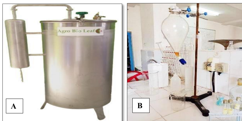
Figure 7. A : Appareil d'hydrodistillation à la vapeur, B : Entonnoir séparateur (Tradi, 2024).
