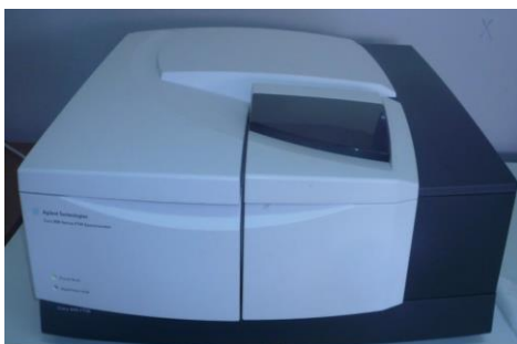
Figure III.4. Image du spectrophotomètre infrarouge Cary 650.
