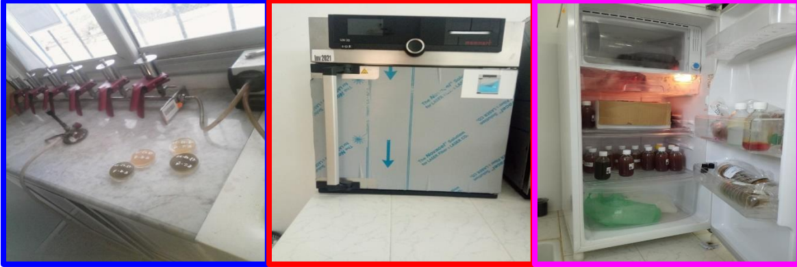
Figure II.32. Matériels pour les analyses bactériologiques. De gauche à droite: La rampe de filtrage, l'étuve et un frigidaire pour le stockage des réactifs.
