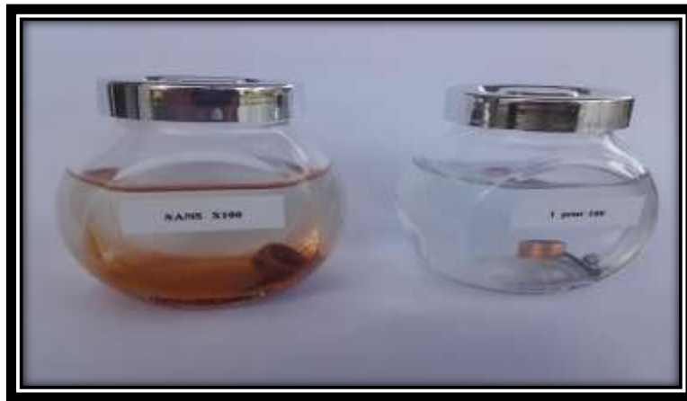
Figure II.1. Intérêt d'un inhibiteur de corrosion : -à gauche, du cuivre, de l'acier, de l'innox et un peu d'eau dans 15cl d'eau de robinet ; - à droite même matériaux avec l'inhibiteur (SANS X100)
