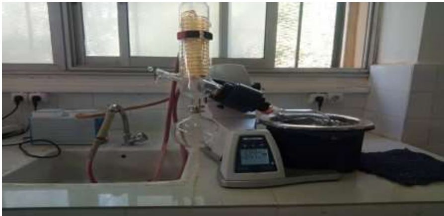
Figure III.6 : Montage d'évaporation – évaporateur rotatif
