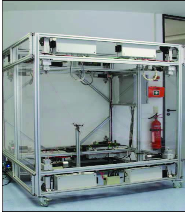
Figure 1.15 Un prototype de robots parallèle à câbles.(Le SEGESTA), développé à l'Université de Duisburg-Essen
