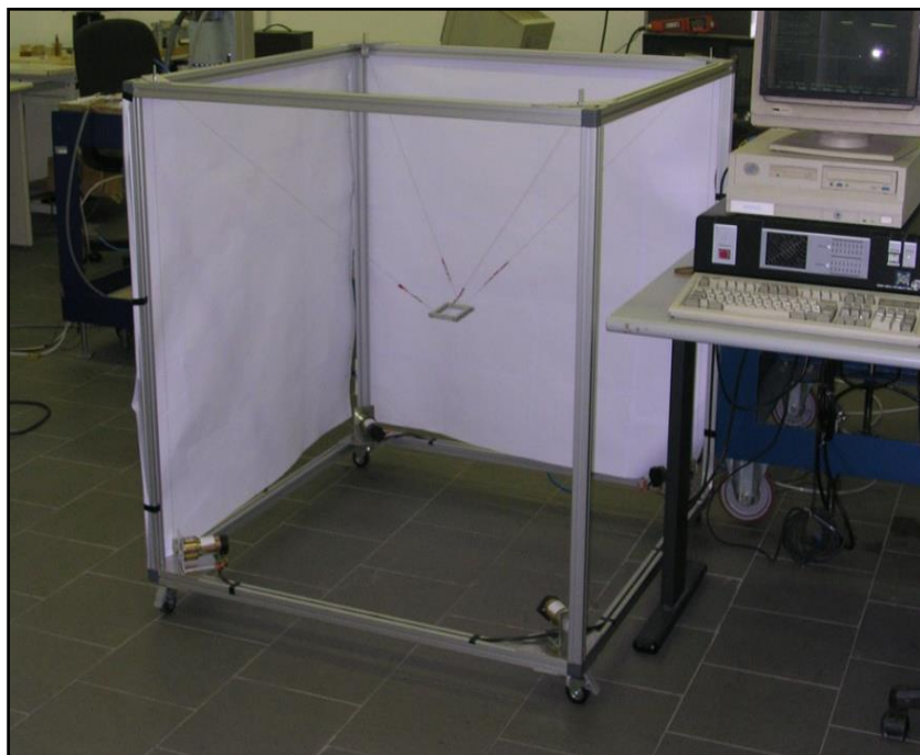
Figure I.8b Cas spatial du robot à 4 câbles du LARM
