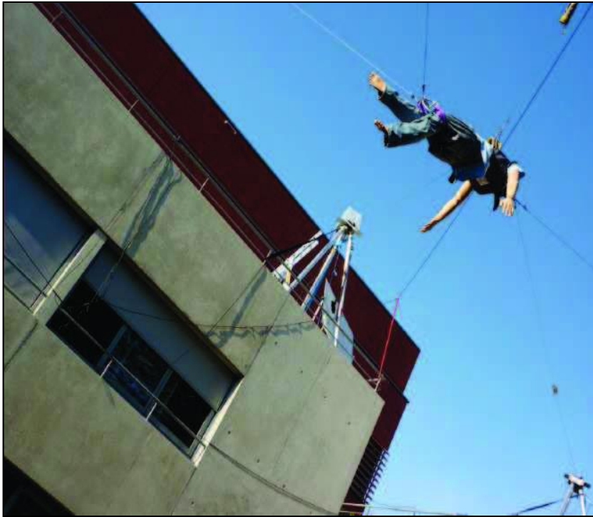
Figure 1.17 Mise en situation du robot de secours MARIONET-CRANE, développé à l'INRIA Sophia-Antipolis par l'équipe projet COPRIN.
