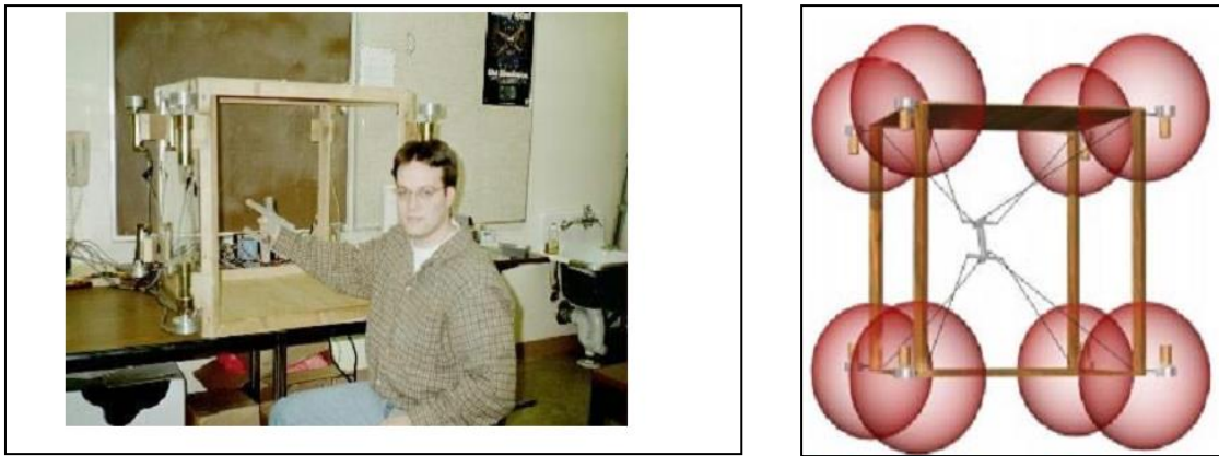
Figure I.12 Interface haptique de 6 degrés de liberté
