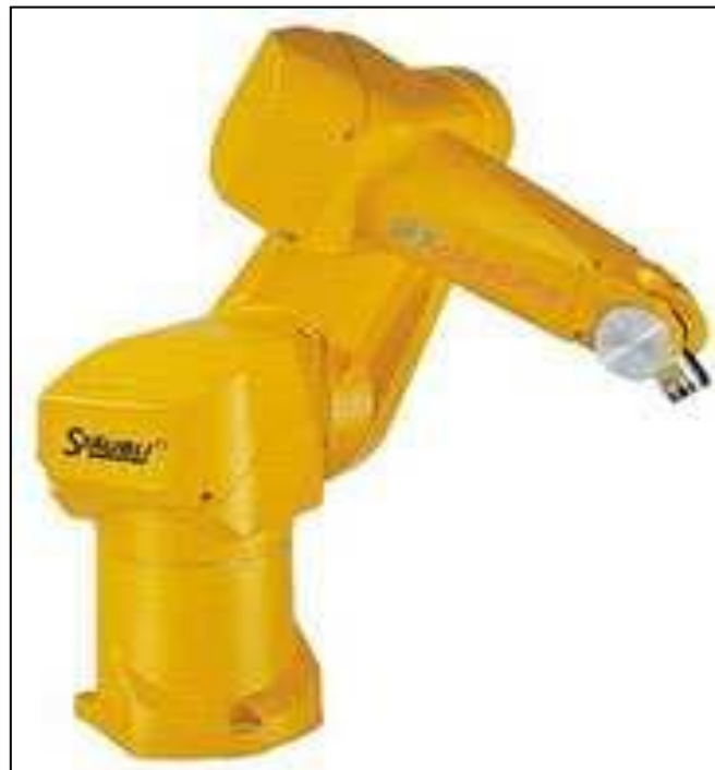
Figure. 1.7 Un exemple de robot sériel
