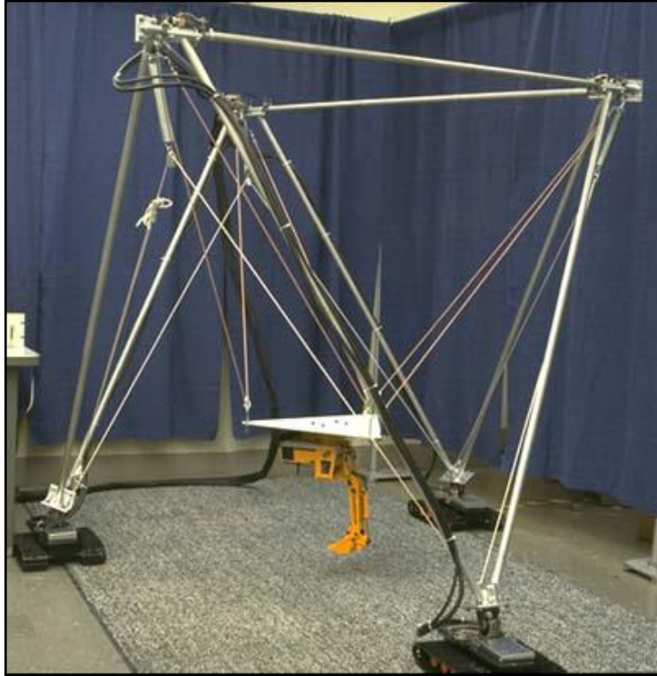
Figure 1.14 Une des versions du NIST Robocrane, un des premiers robots suspendus entraîné par câble.
