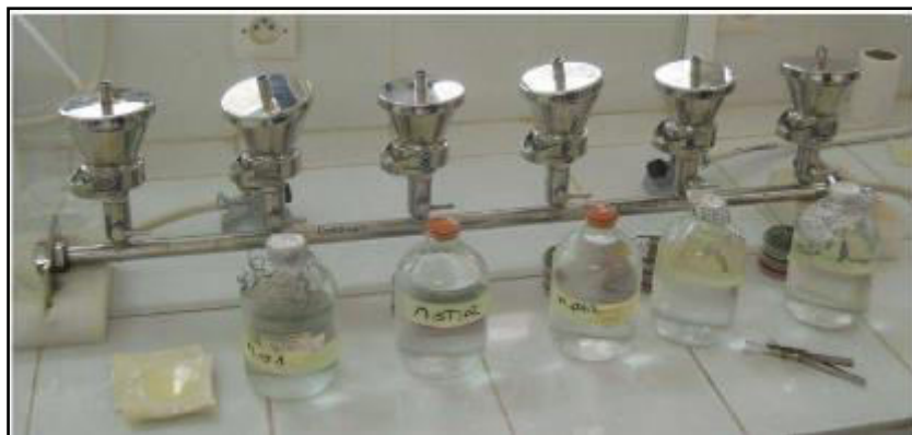
Figure 27 : Dispositif de l'appareil de filtration sur membrane.
