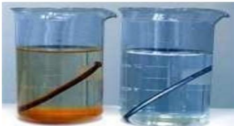
(a) Sans inhibiteur de corrosion (b) avec inhibiteur de corrosion
