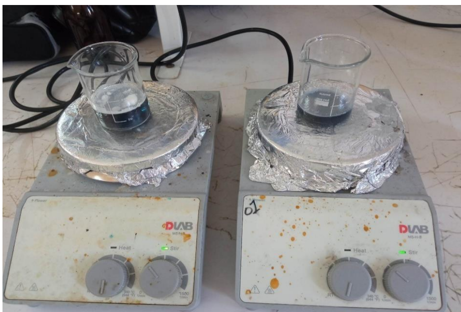
Figure III.1 : synthèse MIL101 et MIL53 pendant l'agitation.
