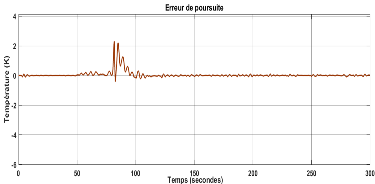
Figure IV-10: L'erreur de poursuite du réacteur CSTR
