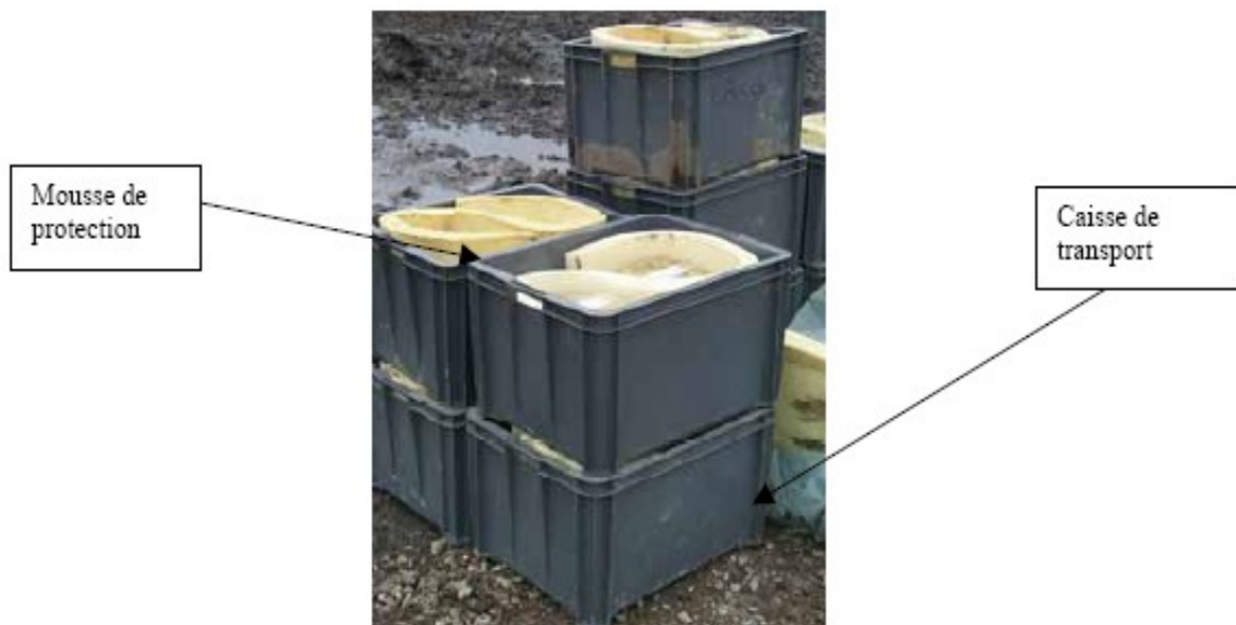
Fig I-17: Conditionnement des échantillons pour le transport
