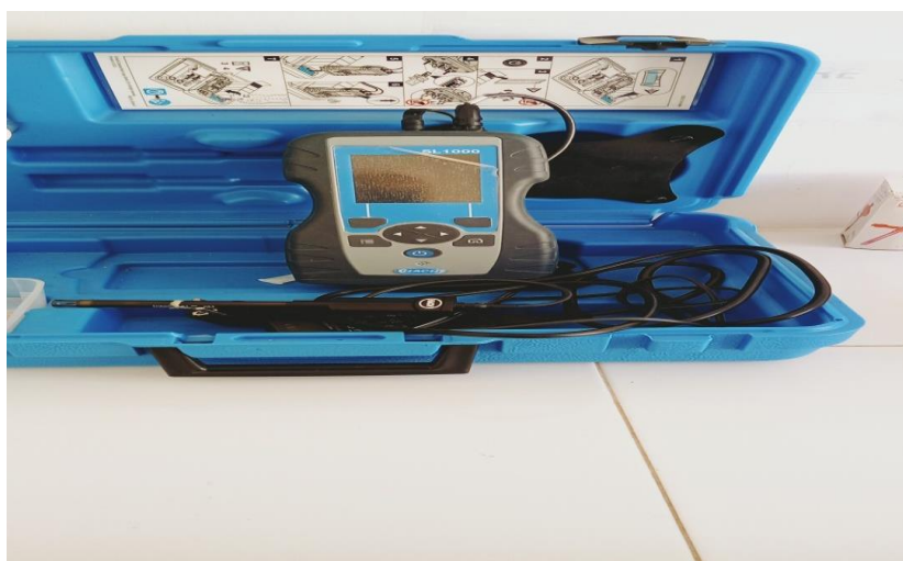
FigII.1. Appareil multi paramètre PH, Température.
