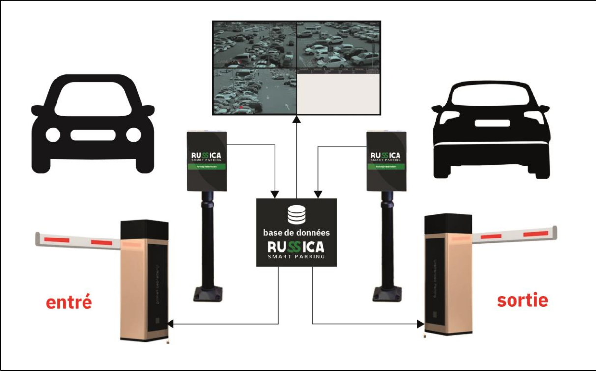
Figure 4.8: schéma de fonctionnement du système " rissica smart parking "
