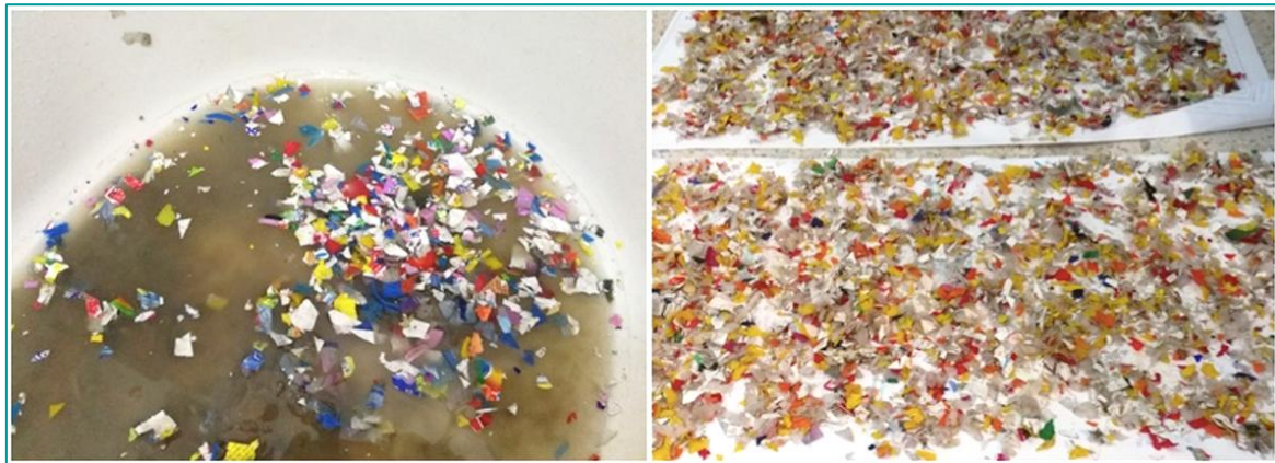
Figure 25 Lavage et séchage des déchets plastiques
