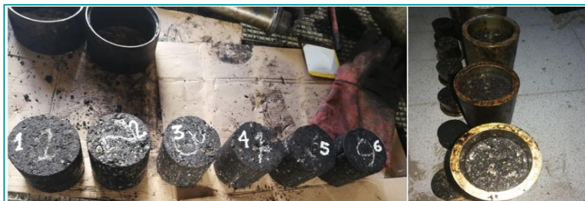
Figure 28 Fabrication d'éprouvettes pour test Duriez.
