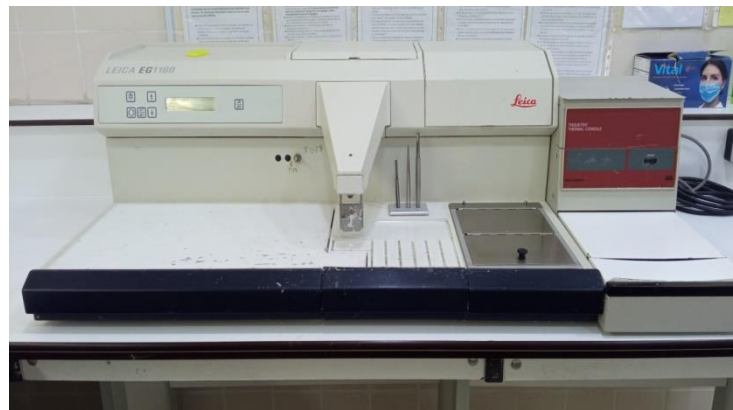
Figure 16 : Station d'enrobage (chambre froid /chaud)(photo originale,2025)
