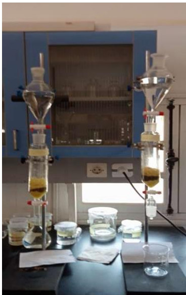
Tube de percolation pour mesurer la CEC
