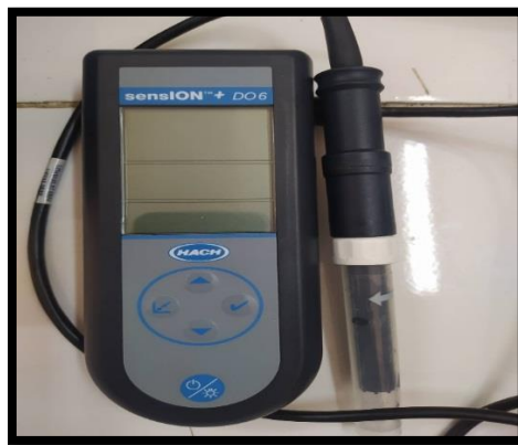
Figure IV.28 :Oxymètre portable de référence HACK sensION tm +DO6
