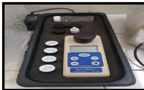
Figure IV.29: Turbidimètrephotomètre de type EUTECH Instruments turbidimeter TN-100
