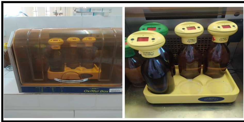
Figure IV.30 : DBO-mètre utilisé pour la mesure de la demande biochimique en oxygène durant 5 jours
