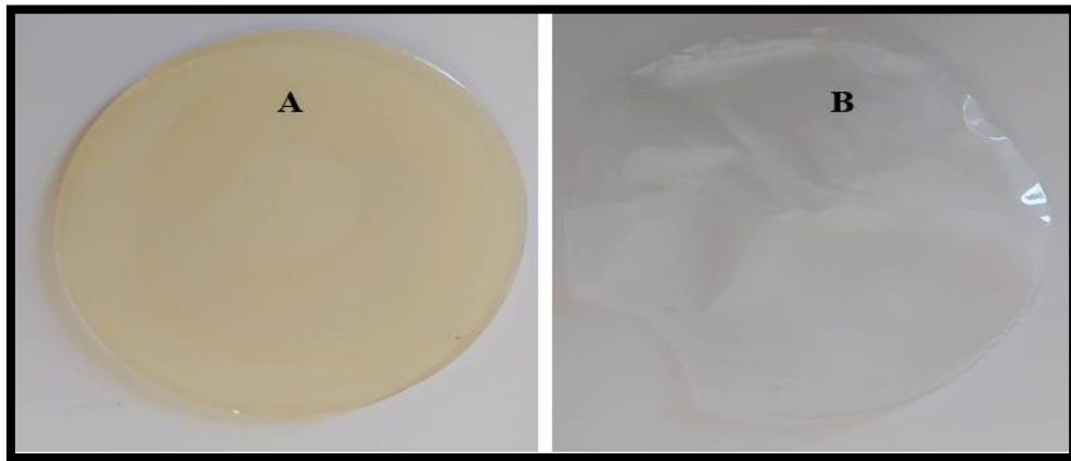
Figure V.46 : Biopolymère élaboré à base d'agar-agar (A). Biopolymère à base d'amidon (B).
