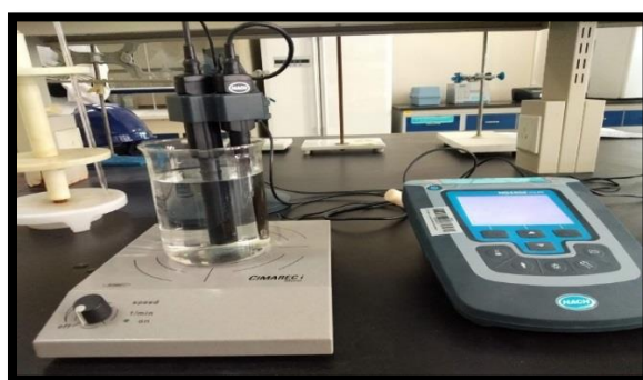
Figure IV.27 : Multi-paramètres de paillasse type HACK multi HQ 40d
