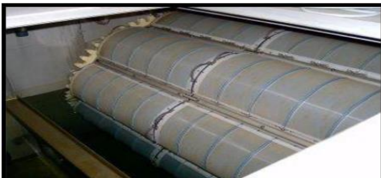
Figure II.3 : Tambours filtrants (pour tamisage et micro-tamisage)
