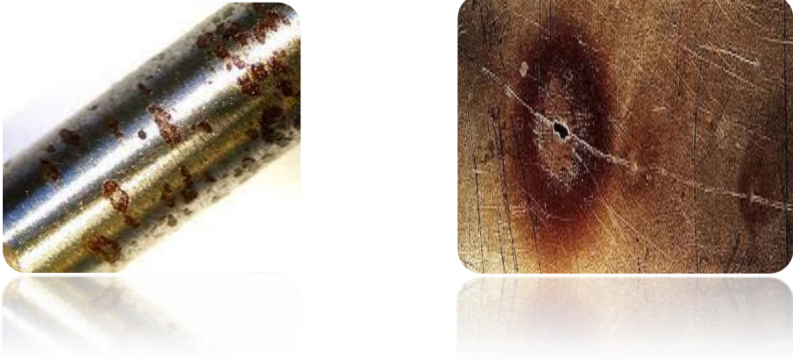
Figure. I.6: La corrosion par piqûres
