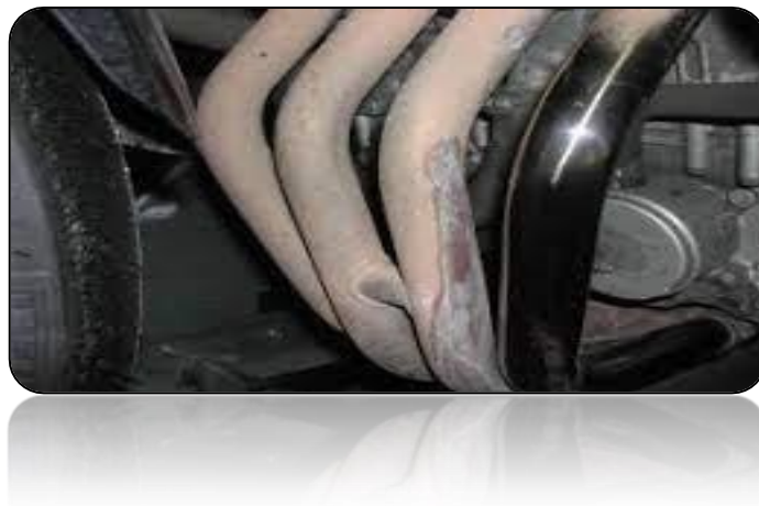
Figure. I.1: exemple de la corrosion d'un collecteur d'échappement.
