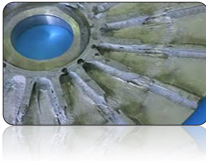
Figure. I.8 : La corrosion caverneuse.
