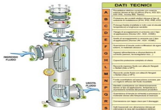
Figure III.12 : Les composants des réchauffeurs électriques [31].
